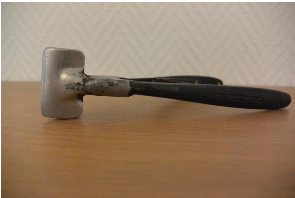
Figur 3. En tång man öppnar musslor med. Tången är tillverkad av en plåtfirma.
